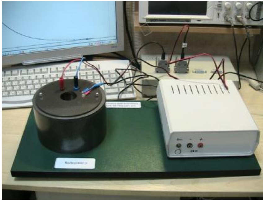
Рис. 4. Лабораторна установка для вимірювання теплоємності металів
