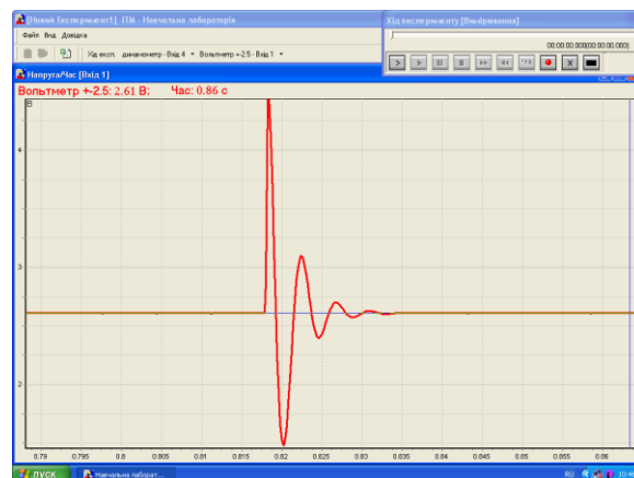
Рис.3. Коливальний процес, відтворений АЦП і ПК
